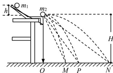
②图中  $O$  点是小球抛出点在地面上的垂直投影。实验时，先让入射球  $m_1$  多次从斜轨上  $S$  位置静止释放，找到其平均落地点的位置  $P$ ，测量平抛射程  $OP$ 。然后，把被碰小球  $m_2$  静置于轨道的水平部分，再将入射球  $m_1$  从斜轨上  $S$  位置静止释放，与小球  $m_2$  相碰，并多次重复。
