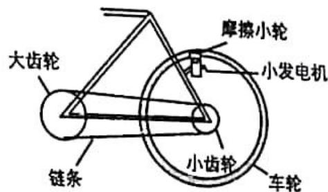
（1）小齿轮和车轮角速度大小相等；大、小齿轮边缘的线速度大小相等，车轮边缘和摩擦小轮边缘线速度大小相等。
